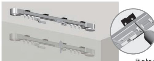
2 Fijar los soportes y despues fijar el riel.
